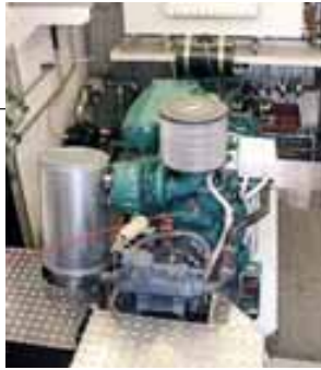
Herzstücke jeder „Spreeblick“ ist der Volvo Penta D 7A-TA mit 130 KW bei 1.900 1/min. mit ZKR-Zulassung
